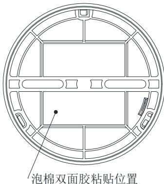
图 6 探测器粘贴安装示意图
