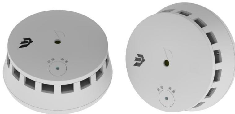
JTW-ZF-JBF-W1110 独立式感温火灾探测报警器 (以下简称感温探测器) 是本公司基于青鸟 Chrip 无线通讯技术开发的无线感温火灾探测报警设备。该探测器是青鸟消防 HRP 无线专网系统的感温探测部件, 主要用于火灾初期温度升高, 当满足报警阈值时, 上报火警信息。本设备同时可以工作在独立模式下工作, 探测报警后现场进行鸣叫报警。
