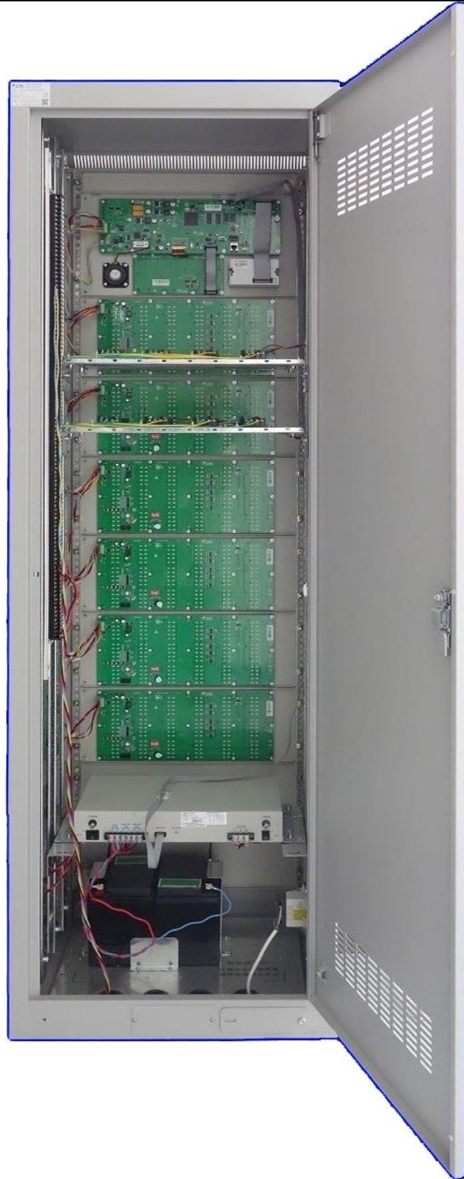
图 5 JBF-61S20-G 柜式机内部结构图
