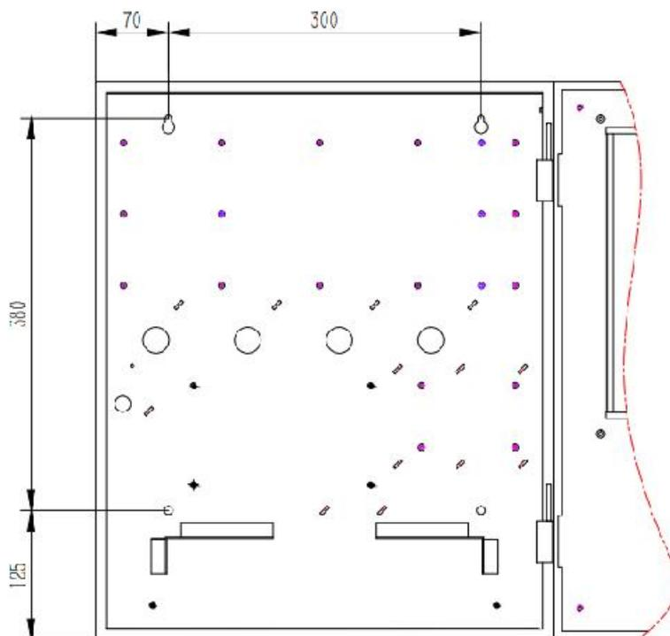
上图为控制器机箱的底面，A、B、C、D为安装孔。
