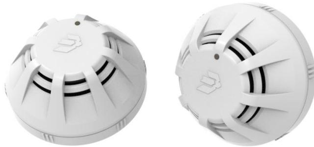
JTY-GD-JBF5100C-Ex 点型光电感烟火灾探测器（以下简称探测器）是青鸟消防股份有限公司开发的本质型感烟探测器，该探测器可以对火灾早期阶段和阴燃阶段所产生的烟雾粒子做出有效的响应，对不同材质燃烧后产生的白烟或黑烟均可响应，主要用来探测可见的燃烧产物及起火速度缓慢的初期火灾，该产品具有较强的抗干扰能力。
